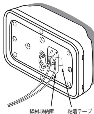
圧着端子等で接続した線材はスピーカ裏蓋の線材収納庫に入れ、上から粘着テープで止めてください。
