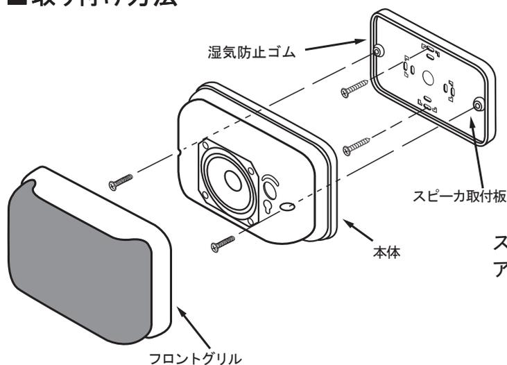
スピーカー取付板をネジで壁に取付けた後、本体を付属のネジで取付け、フロントグリルを付けてください。
