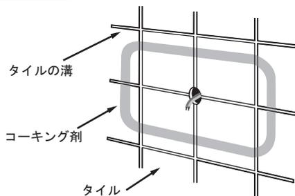
スピーカを取り付ける壁の表面に溝等がある場合は、この溝から壁裏への湿気の回り込みを防水するために、湿気防止ゴムの裏側をコーキングし、湿気止めをしてください。
