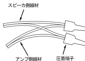
スピーカー側線材(⊕は赤線材、⊖は黒線材)とアンプ側線材を圧着端子等で接続してください。
