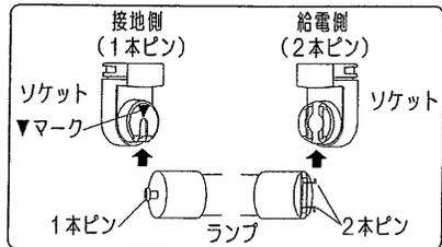
・ソケットの奥まで挿入して確実に取付けてください。
